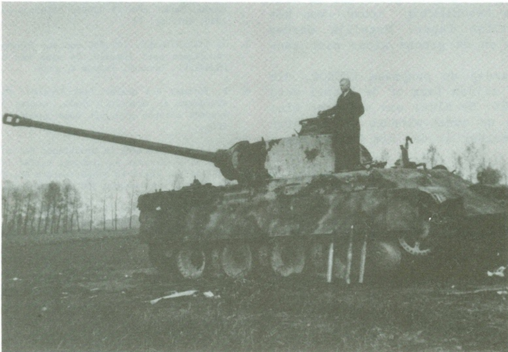
Een zeer gehavende Panther Ausf.G van Panzerabteilung 2107 van de 107e Panzerbrigade, uitgeschakeld nabij ?. Goed zichtbaar is hier de eerste versie van het schietgatpantser. Een groot gedeelte van het zimmeritpleister is verdwenen en daarmee ook de camouflageverf, maar op de Skürzen is het wolkachtige (gespoten) driekleurige camouflage-schema nog goed te zien.
